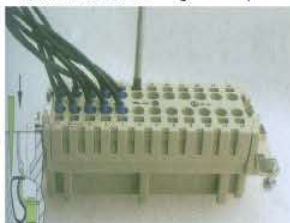
Step 1 螺钉起子插入正方形插孔中，弹片被推向一侧，从而打开接线口。
